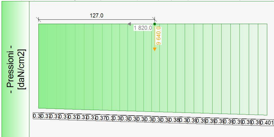
Forze (totali) e Pressioni lungo il fusto, per il Caso 10 ( FREQ. [ Frequente ] - Combinazione frequente - SLE )
